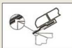
Nie szlifować boczną powierzchnią ściernicy. Możliwość zniszczenia wzmocnienia
